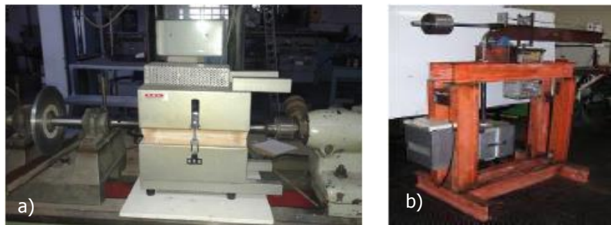
Fig. 1: Máquinas de ensayo de creep por: a) torsión b) tracción.
