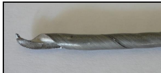
Fig. 2: Superficie de fractura del alambre B
