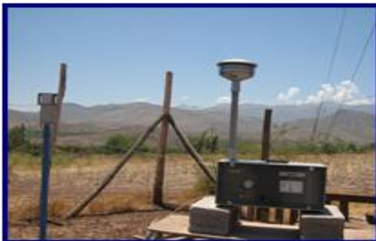
Fig 3: Equipo de medición Sartorius, para material particulado P.M. 2,5.
