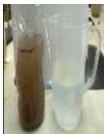
Fig. 5: Agua con agente coagulante y agua filtrada.
