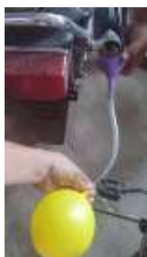
Fig. 3: Toma de muestra de gases de escape desde un ciclomotor.
