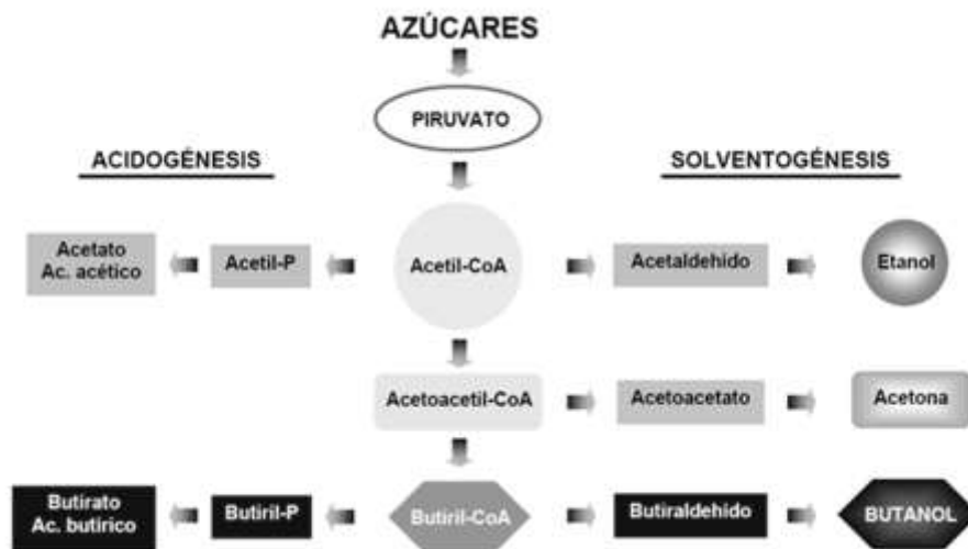
Fig. 5: Proceso de fermentación acetona-butanol-etanol (ABE) catalizada por enzimas.
