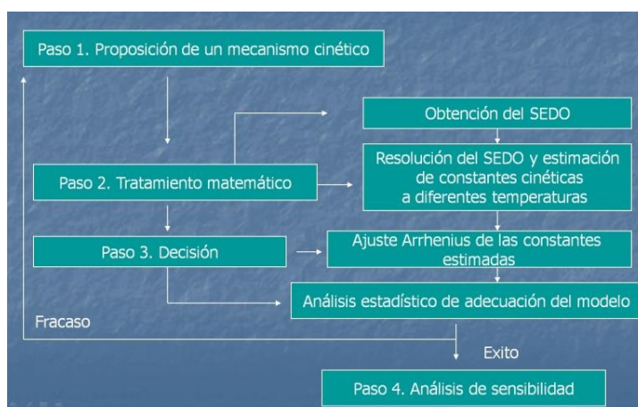
Fig. 6: Metodología de trabajo para encontrar una fenomenología de polimerización del metacrilato de furfurilo a diferentes temperaturas
