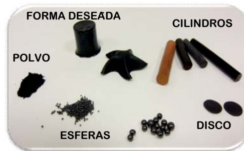
Fig. 4: Xerogeles de carbono obtenidos en diferentes formas finales
