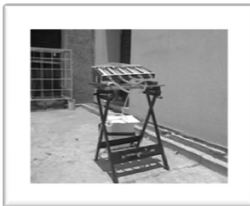
Fig. 1: Reactor tipo colector cilíndrico parabólico empleado en la degradación fotocatalítica de cianuro.
