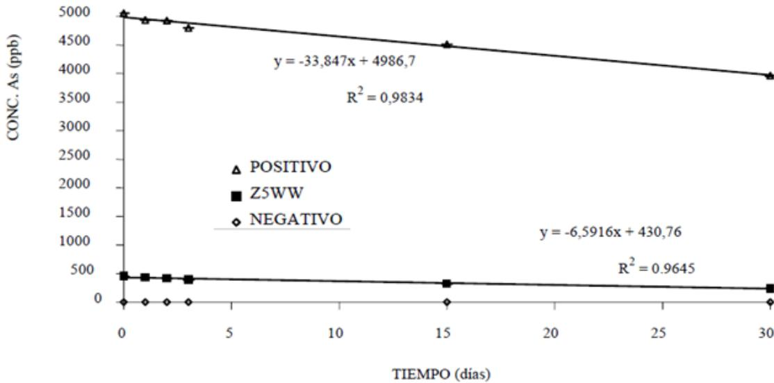
Fig. 2: Disminución de la concentración de As en las aguas en función del tiempo.
